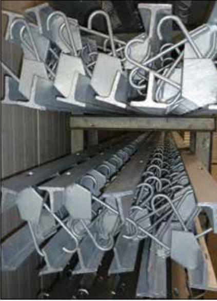
Feuerverzinkte Stahlkonstruktion zum Abschluss der Abdichtung bei Dehnrwegen.
